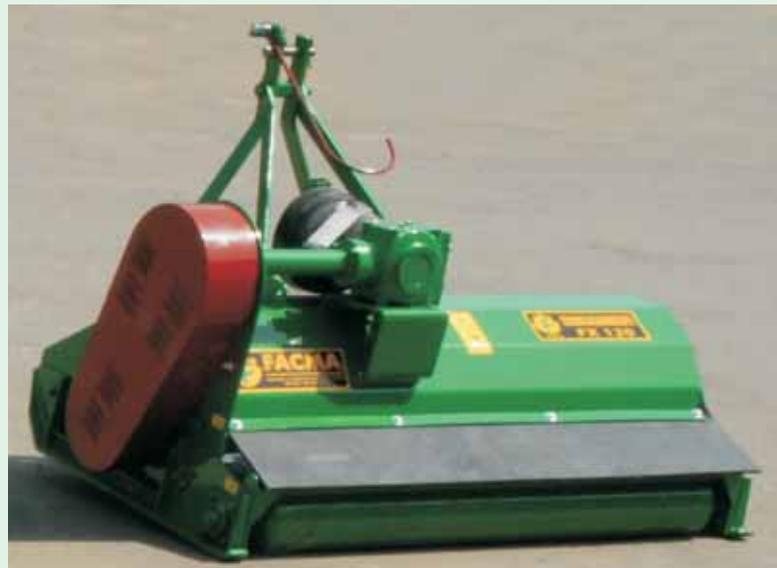
**Il modello FX è idoneo alla trinciatura di manti erbosi, sarmenti e pietre fino a 6 - 7 cm di diametro. E' una trinciasarmenti con attacco fisso, applicabile ai tre punti del sollevamento idraulico posteriore di trattori con potenza compresa tra 18 e 85 CV.**
