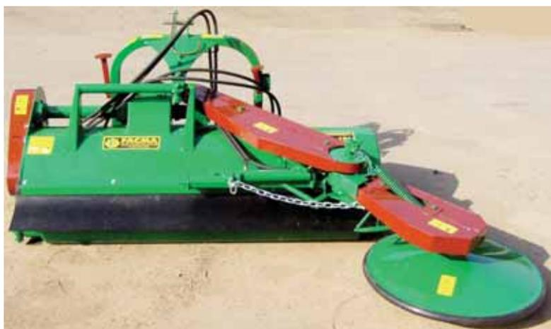
🇮🇹 Disco Interfilare a Cinghie con trasmissione meccanica tramite cinghia.
