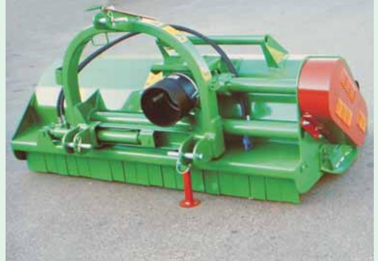
**Il modello XPEL è adatto alla trinciatura in terreni sassosi, irregolari e per la manutenzione di zone boschive. La struttura nella totalità dei suoi componenti è particolarmente robusta,** tale da trinciare residui di potatura di grandi dimensioni (circa 10 - 15 cm di diametro) e pietre muovibili fino a 25 cm di diametro. L'attacco è disponibile spostabile manualmente o idraulicamente. Applicabile a trattori con potenza compresa tra 45 e 120 CV.
