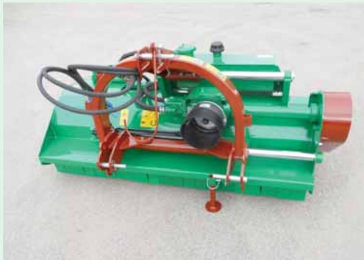
**Il modello BVE consente di ottenere uno sminuzzamento dell'erba maggiore rispetto al modello BPEL.** Il modello BVE è indicato per la trinciatura di manti erbosi, sarmenti e pietre fino a 6 – 7 cm di diametro nei frutteti. L'attacco è disponibile spostabile manualmente o idraulicamente. Applicabile a trattori con potenza compresa tra 40 e 110 CV.
