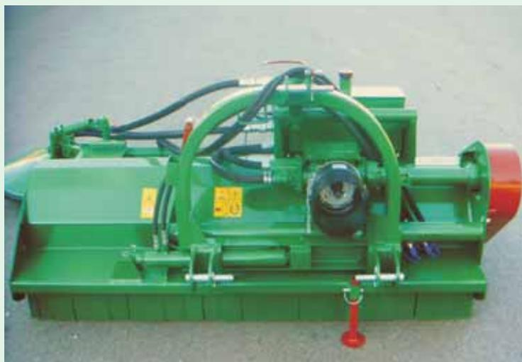
**Il modello BPEL è indicato per la trinciatura di manti erbosi, sarmenti e pietre fino a 6 – 7 cm di diametro nei frutteti.** L'alta velocità di rotazione delle mazze permette un ottimale sminuzzamento dell'erba e dei sarmenti. L'attacco è disponibile spostabile manualmente o idraulicamente. Applicabile a trattori con potenza compresa tra 25 e 100 CV.
