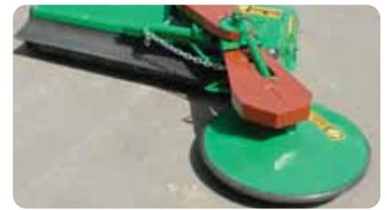
Disco interfilare idraulico (per tutti i modelli – escluso reversibili)
